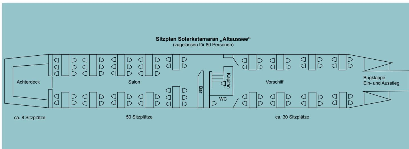
Der 1998 in der Österreichischen Schiffswerften AG Korneuburg erbaute Aluminium-Katamaran verfügt über rund 35 m<sup>2</sup> Solarmodule. Das erste Solarschiff der österreichischen Fahrgastschiffahrt bietet Platz für bis zu 80 Personen.
